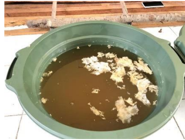
Pengendapan 25% limbah cair industri tahu + 75% air gambut
