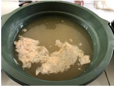
Pengendapan 50% limbah cair industri tahu + 50% air gambut
