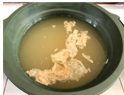
Pengendapan 75% limbah cair industri tahu + 25% air gambut
