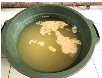
Pengendapan 100% limbah cair industri tahu
