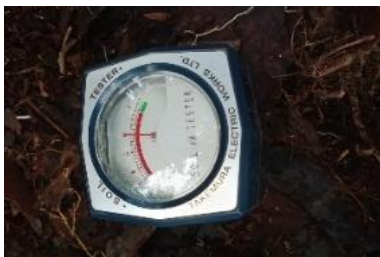
Pengukuran pH tanah menggunakan soil tester
