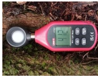
Pengukuran intensitas cahaya matahari menggunakan lux meter
