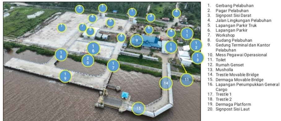
Lampiran 10.1 Gambar Denah Fasilitas Pelabuhan Penyeberangan Bahaur
